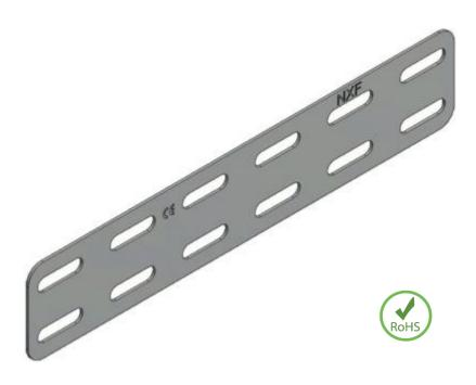
Eclisse plate pour tous types de dalles perforées fixation par 4 boulons poêliers TRCC M6x12 + écrou HE.
