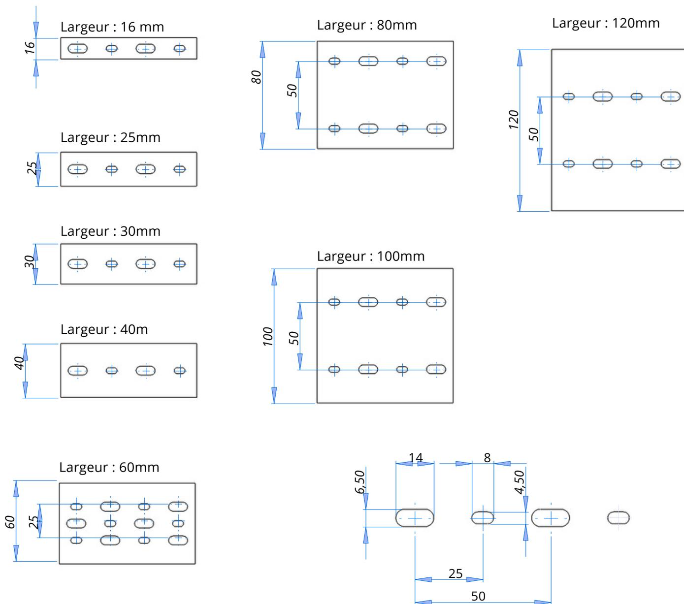
Les perforations de tous les fonds des goulottes de câblage (1 à 3 rangées) sont conformes à la recommandation DIN EN 50085-2-3.
